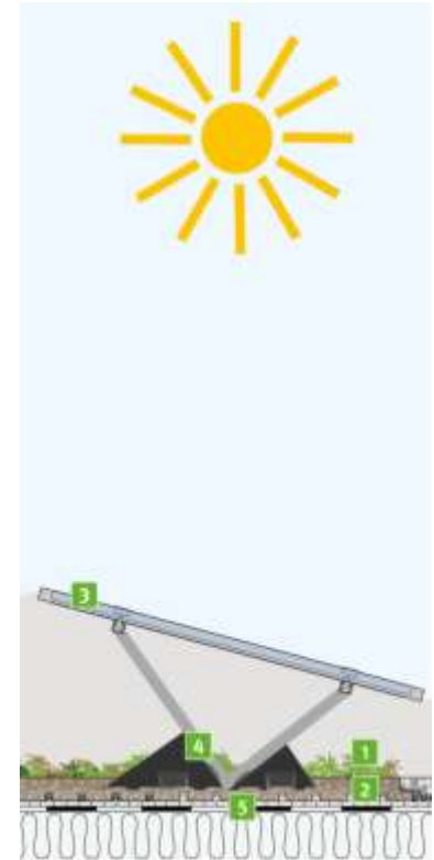
Abb. 130: PV-Auflastanlage mit extensiver Dachbegrünung (Foto: ZinCo GmbH )
