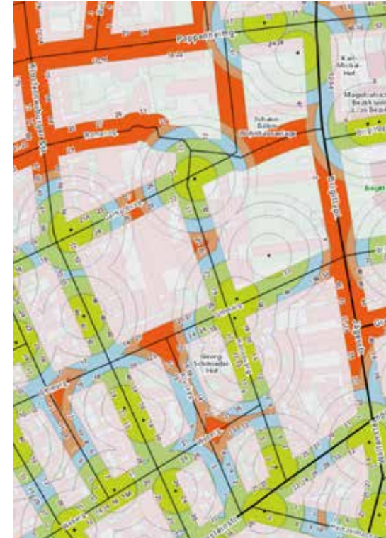
Abb. 16: Distanz zur nächsten Radabstellanlage – unter 45 m (grün), 45–60 m (blau), 60–70 m (braun), über 70 m (orange) 17
