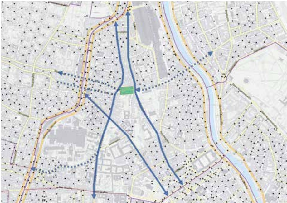
Abb. 14: Verkehrsberuhigungsmaßnahme im Bereich Alserbachstraße zwischen Nußdorfer Straße und Liechtensteinstraße (grün: Primärmaßnahme, blau strichliert: deutlich entlastete Straßenabschnitte) 9
