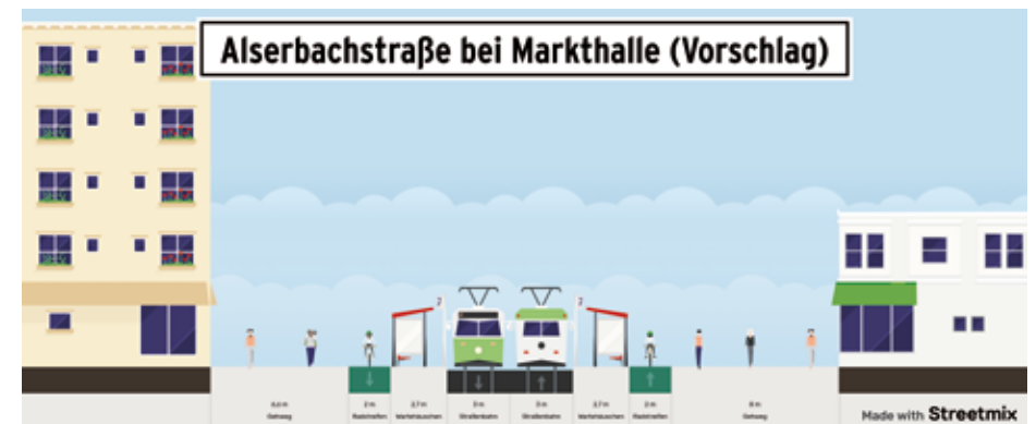
Abb. 20: Querschnitt Alserbachstraße bei Markthalle, Umplanungsvorschlag
