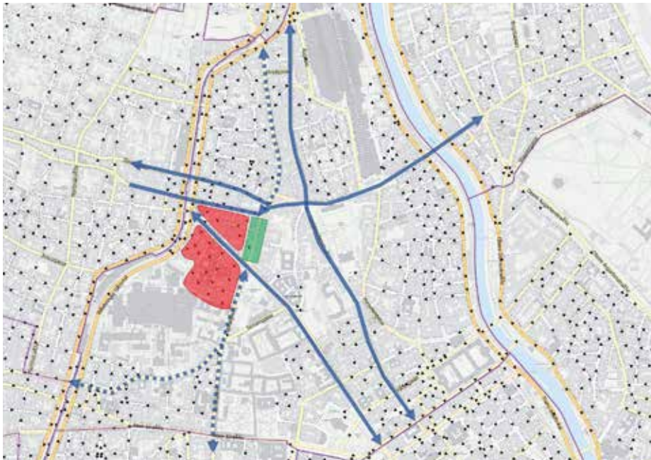
Abb. 13: Verkehrsberuhigungsmaßnahme im Bereich Spitalgasse zwischen Währinger Straße und Fuchsthallergasse (grün: Primärmaßnahme, rot: Begleitmaßnahmen notwendig, blau strichliert: deutlich entlastete Straßenabschnitte) 8
