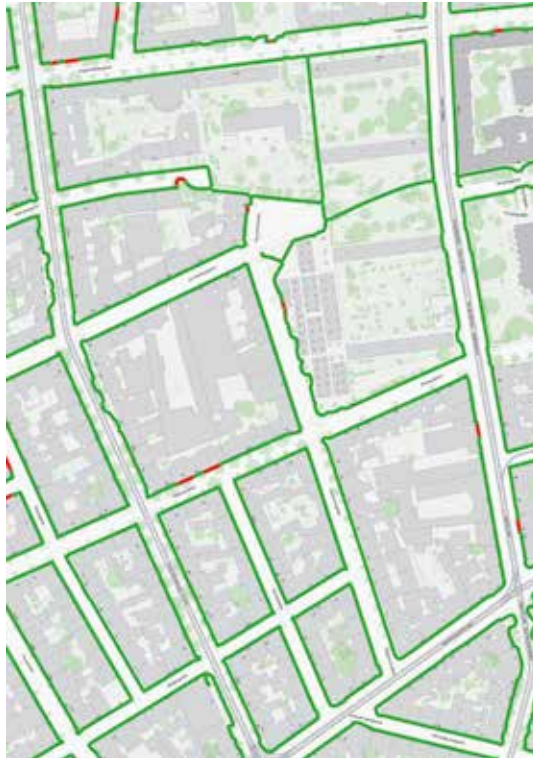
Abb. 17: Gehsteigbreiten – unter 2 m (rot), über 2 m (grün) 18
